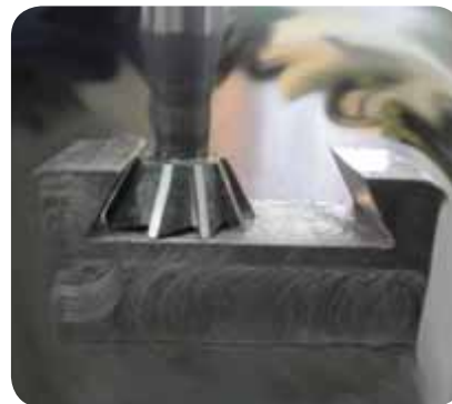
نحوه ایجاد شیار دم چلچله در قطعه
