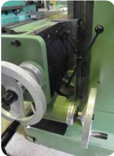
اهرم حرکت اتوماتیک، فلکه‌های دستی و قفل کننده
