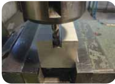
جابجایی تیغه فرز انگشتی برای افزایش پهناي شیار
