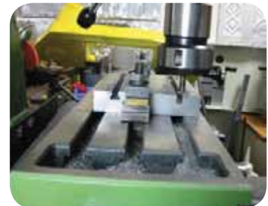
زدن شیار راست گوشه در ابتدای ایجاد شیار T
