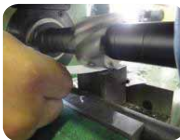
روش مماس کردن ابزار با سطح قطعه کار
