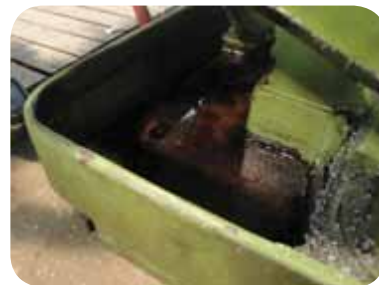
پایه ماشین محلی برای ذخیره مایع خنک کننده
