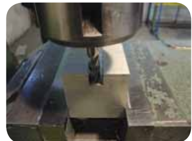
شیار تراشی با تیغه فرز انگشتی
