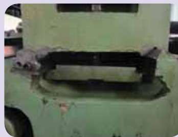
شيار دم چلچله ای بستر ماشین تراش
