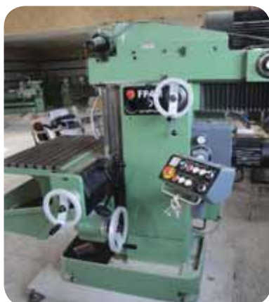
فلکه‌های دستگاه برای جابجایی دستی
