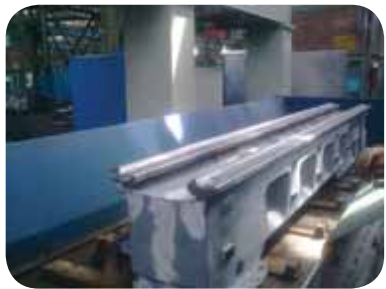
بستر ماشین تراش با شیار V شکل در سطح راهنمای آن
