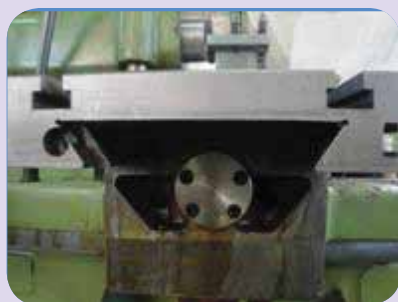
کاربرد شیار دم چلچله ای در سوپرت دستگاه
