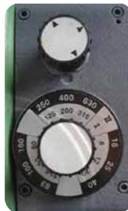
فلکه تنظیم پیشروی
