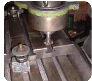
ایجاد شیار T شکل پس از ایجاد شیار راست گوشه
