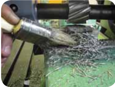
نحوه دور کردن براده ها
