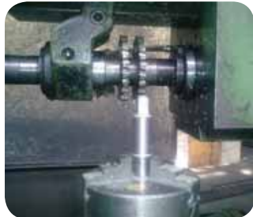
زدن دو سطح بغل به صورت هم زمان (استرادل)
