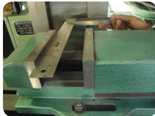
تنظیم فک‌های گیره با استفاده از گونیا
