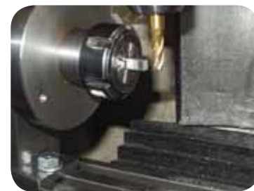
چهارگوش کردن قطعه به کمک دستگاه تقسیم
