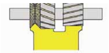
کوپله کردن چند تیغه فرز و انجام چند مرحله کار با هم
