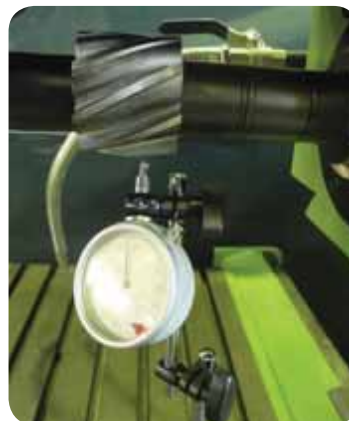
کنترل لنگی میله فرزگیر با ساعت اندازه گیری
