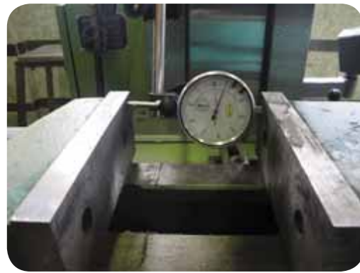
کنترل گونیا بودن فک‌های گیره نسبت به میز دستگاه
