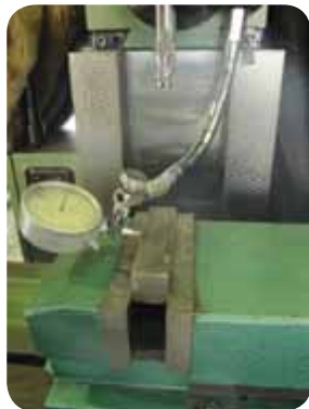
استفاده از بلوک‌های صیقلی برای کنترل فک‌های گیره
