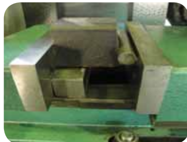
قرار دادن میله گرد بین قطعه کار و فک متحرک گیره
