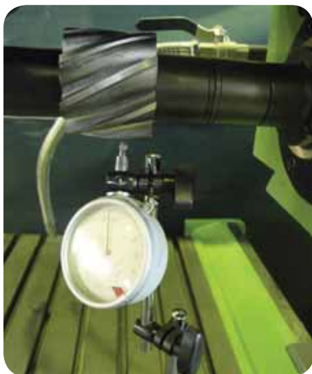
کنترل دور بودن تیغه فرز با ساعت اندازه گیری
