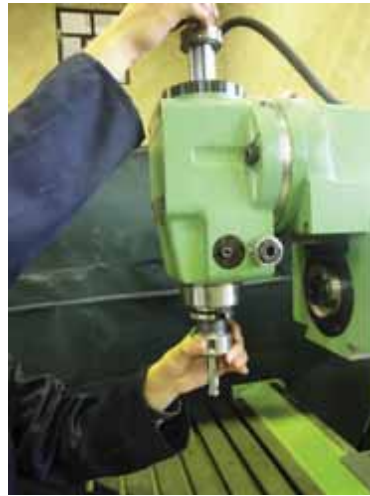
نحوه بستن کُلت بر روی دستگاه
