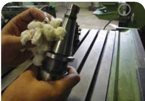
تمیز کردن دنباله میله فرزگیر
