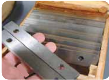
استفاده از بلوک یا شمش برای پر کردن زیر کار
