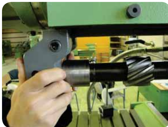
قرار دادن یاتاقان نگهدارنده سر میله فرزگیر را بر روی کشویی دستگاه
