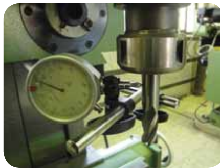
کنترل دور بودن تیغه فرز از لنگی با ساعت اندازه‌گیری
