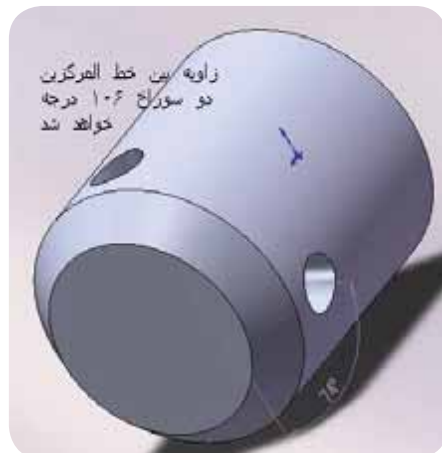
دو سوراخ بر روی محیط استوانه با زاویه ۱۰۶ درجه
