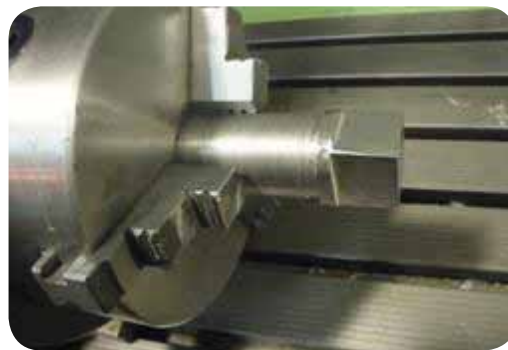
چند وجهی کردن قطعه به کمک دستگاه تقسیم
