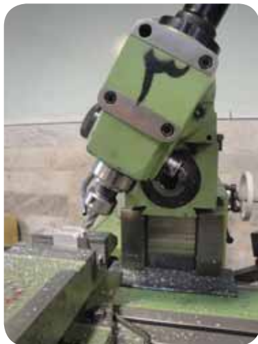
زاویه دادن کله‌گی به اندازه زاویه مورد نظر
