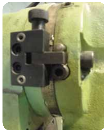
پیچ‌های کله‌گی برای شل کردن و گردش آن
