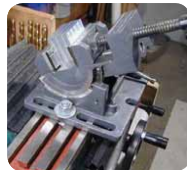
زاویه دار کردن قطعه به کمک گیره انیورسال
