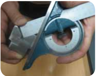
کنترل شیب قطعه با زاویه سنج انیورسال
