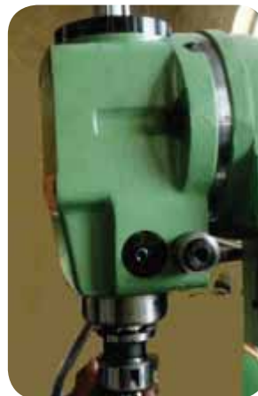
تصویری از محور استوانه‌ای دستگاه و پیچ تثبیت آن
