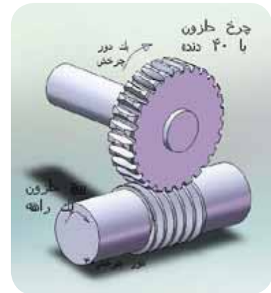
سیستم چرخ حلزون و پیچ حلزون
