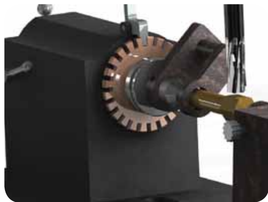
چند ضلعی تراشی با استفاده از ماشین فرز عمودی
