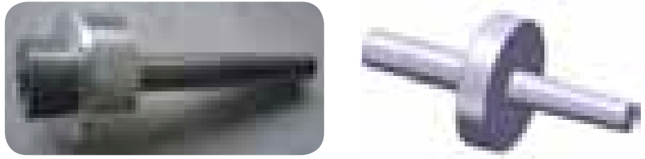
سوار کردن قطعه بر روی محور مخروطی
