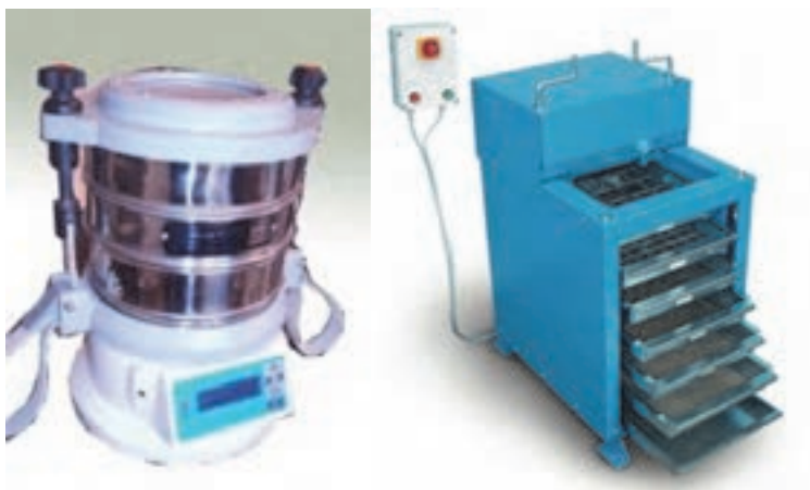
شکل ۱۰- دستگاه لرزاننده در اشکال و ابعاد مختلف
