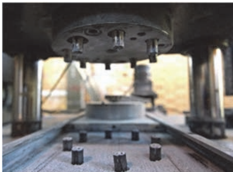
شکل ۱۱- پرس با قالب حاوی ۸ حفره
