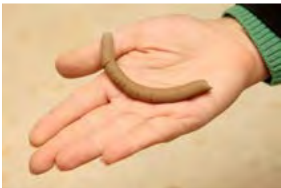
شکل ۱۵- بررسی فتيله در روش آتربرگ
