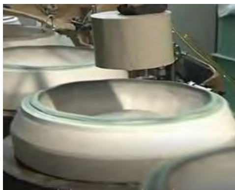
شکل ۳۸- قرار دادن دیسک گل در قالب
