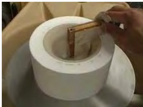
شکل ۳۹- پایین آوردن بازوی جولی و شکل‌دهی
