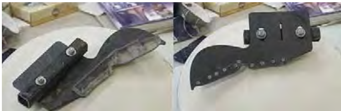
شکل ۲۰- شابلون با پیچ و مهره قابل تنظیم
