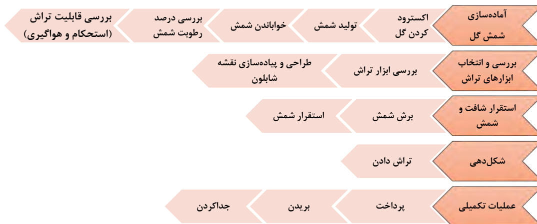
شکل ۷- مراحل شکل‌دهی گل پلاستیک به روش تراش
