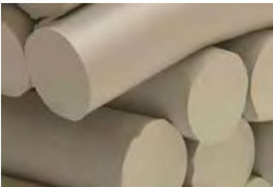
شکل ۸- اکستروود کردن گل پلاستیک
