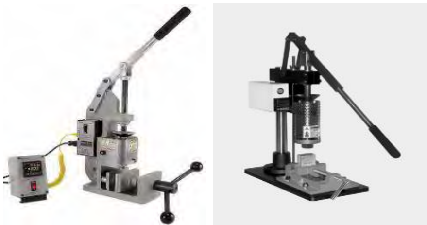
شکل ۲۱- دستگاه نیمه‌اتوماتیک (دستی) قالبگیری تزریقی
