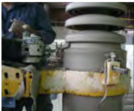
شکل ۵- شکل‌دهی قطعات سرامیکی به روش تراش
