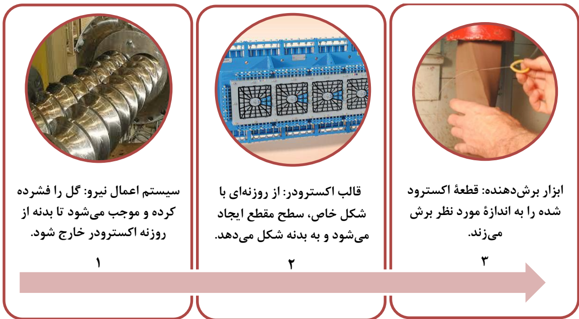
شکل ۶- اجزاء ماشین اکسترودر
