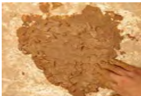
شکل ۱۱- تهیه گل یکنواخت با دوغاب
