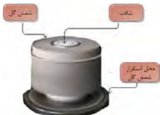
شکل ۱۵- استقرار شافت و شمش گل
