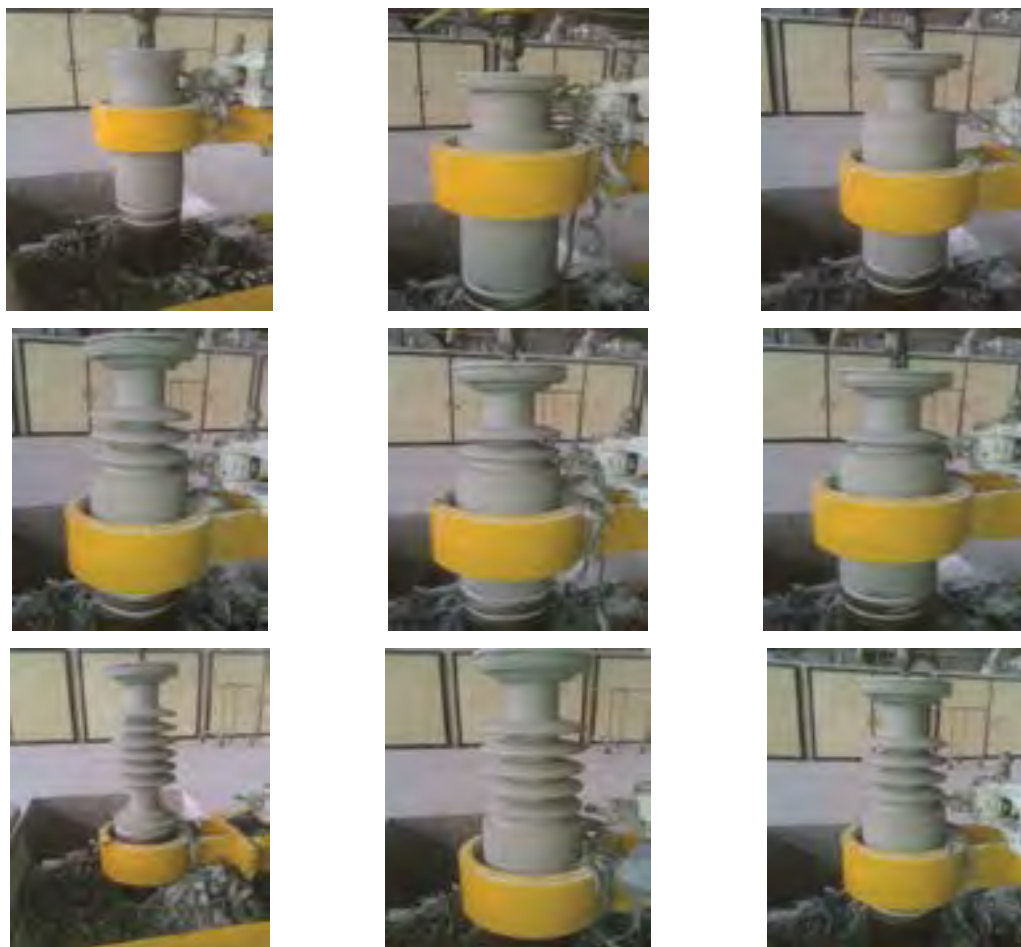
شکل ۲۳- مراحل تراش مقره پوشینگ
