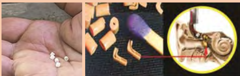
شکل ۱۴- میکروسازه ای به وزن ۰/۰۰۲۲ گرم مورد استفاده در سمعک
