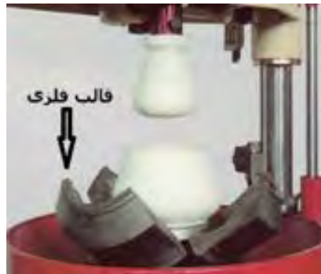
شکل ۱۲- قالب فلزی چند تکه مورد استفاده در روش جیگر و جولی
