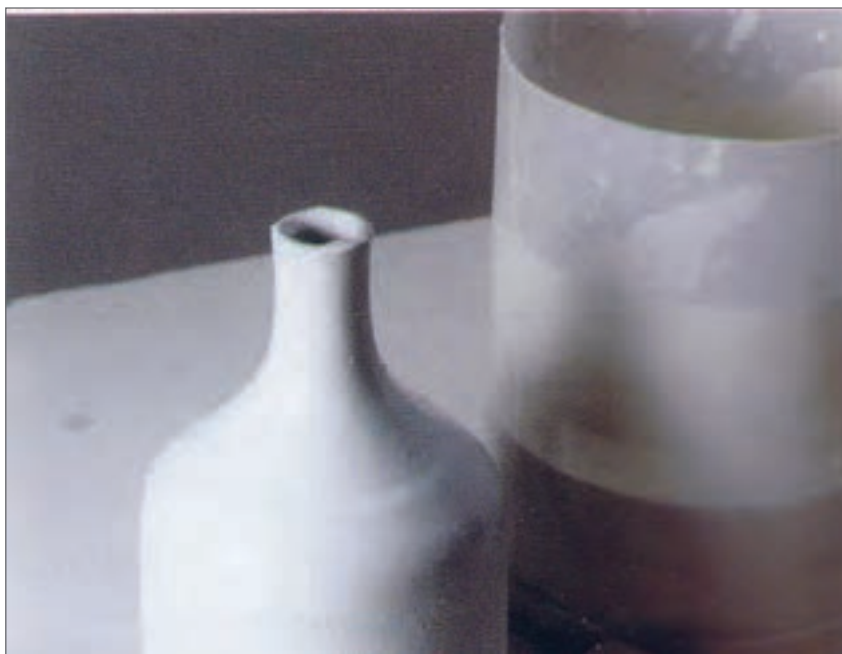
شکل ۱۸- قطعه لعاب‌زده شده به روش غوطه‌وری
