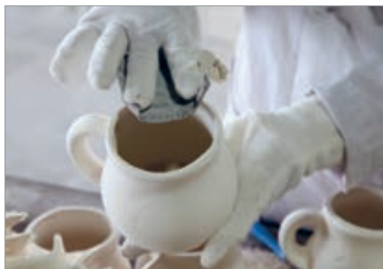
شکل ۱۰- پرداخت خشک قطعه شکل دهی شده با اسکاچ و سنباده
