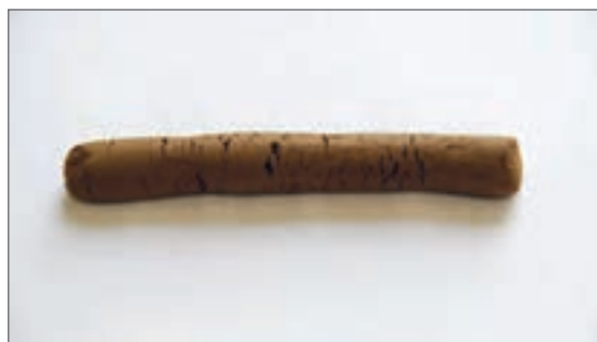
گل با شکل‌پذیری نامناسب - دارای ترک
