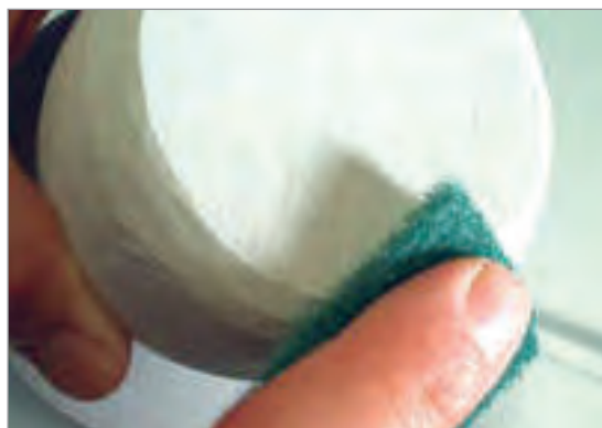
شکل ۱۰- پرداخت خشک قطعه شکل دهی شده با اسکاچ و سنباده
