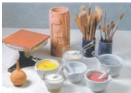
شکل ۱۰- تجهیزات مورد استفاده جهت لعاب‌زنی با قلم‌مو
