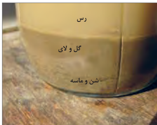
شکل ۱۹- لایه‌های مختلف دوغاب رس
