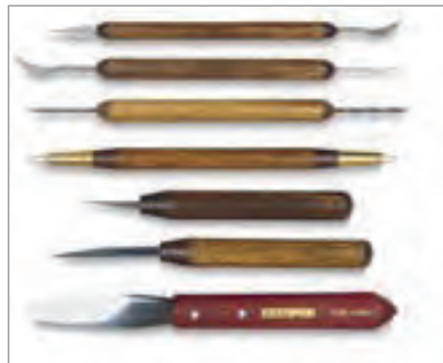
شکل ۱۱- ابزارهای برشی برای ایجاد نقش بریده
