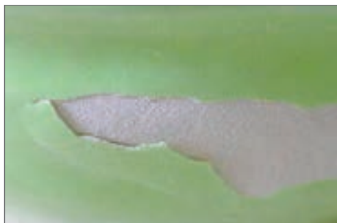
شکل ۲۸- عیب پوسته شدن لعاب
