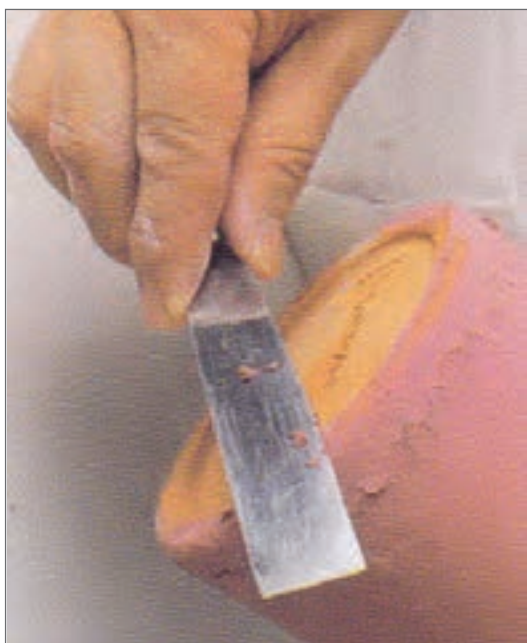
شکل ۱۵- پاک کردن کف قطعه از لعاب
