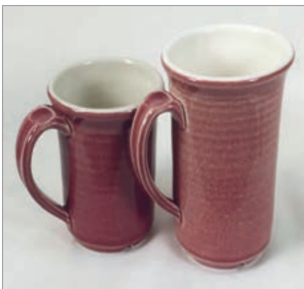
شکل ۲۶- لعاب با دمای پخت نامناسب
