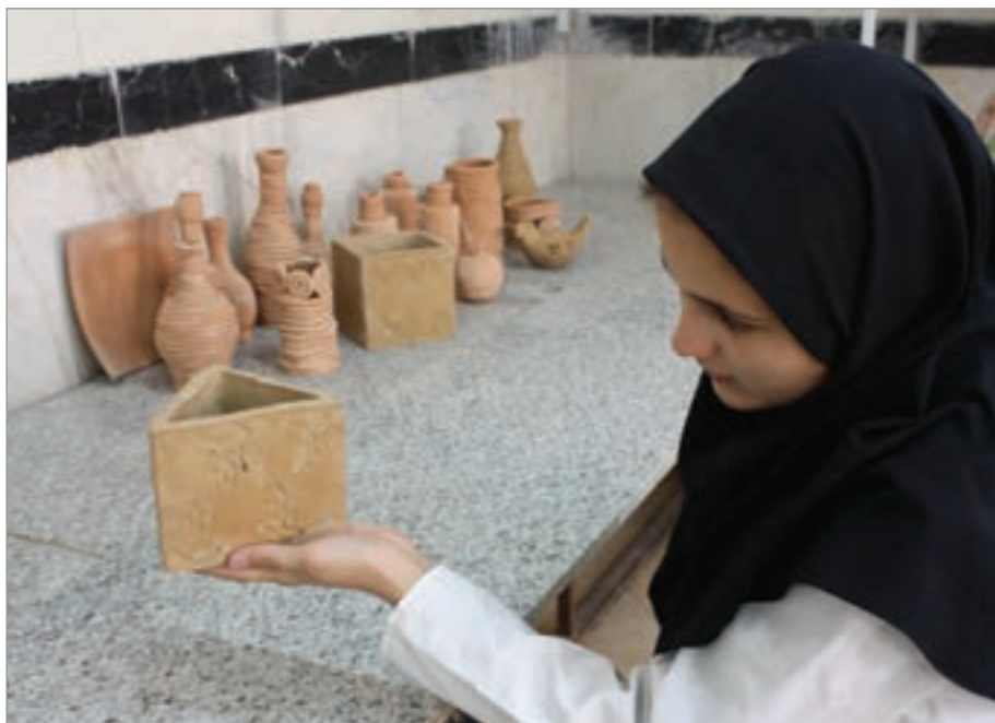
شکل ۱۴- کنترل چشمی فرآورده‌های سرامیکی تولید شده به روش دستی
