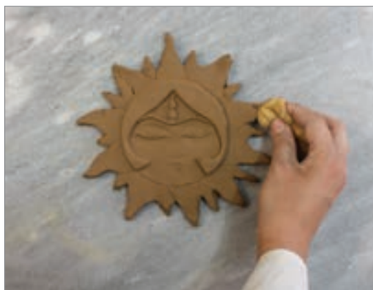
شکل ۷- پرداخت محصولات سرامیکی با ابزارهای مختلف
