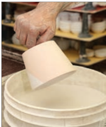
شکل ۱۶- خارج کردن قطعه در روش غوطه‌وری
