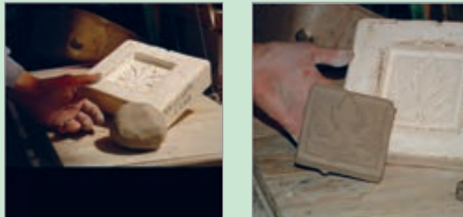
مواد و ابزار: گل، قالب، وردنه و ابزار تراش
