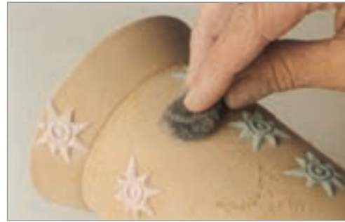
شکل ۱۵- پرداخت بدنه پس از قرار دادن طرح
