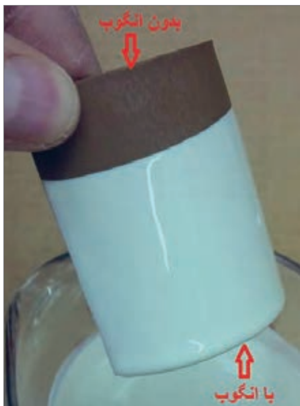
شکل ۸- قطعه بدون انگوب و بعد از اعمال انگوب
