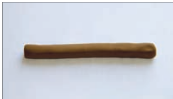
گل با شکل‌پذیری مناسب - بدون ترک
