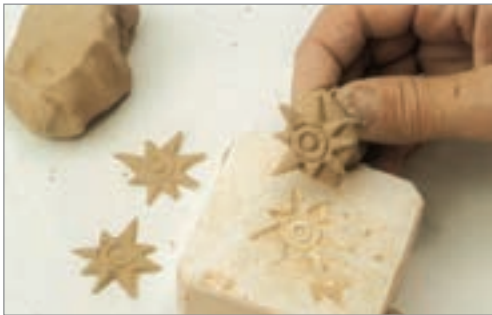
شکل ۱۴- فشار دادن مقداری گل درون قالب
