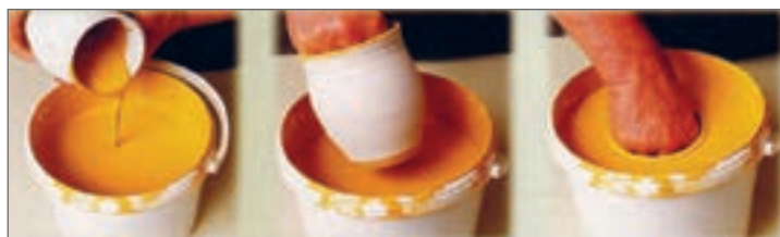
شکل ۱۹- لعاب‌زنی به صورت دستی و کارگاهی
