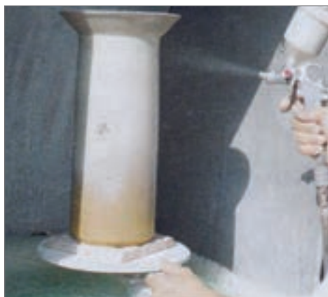
شکل ۲۲- کابین لعاب‌زنی (سمت راست)، لعاب‌زنی با استفاده از روش اسپری کردن (سمت چپ)
