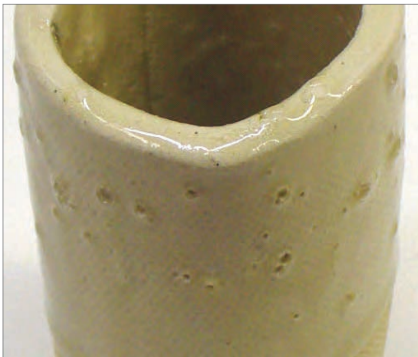
شکل ۳۵- عیب تاول زدن لعاب
