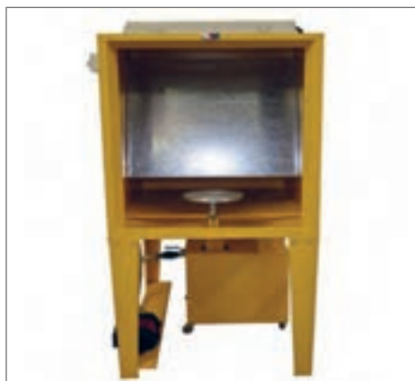
شکل ۲۲- کابین لعاب‌زنی (سمت راست)، لعاب‌زنی با استفاده از روش اسپری کردن (سمت چپ)
