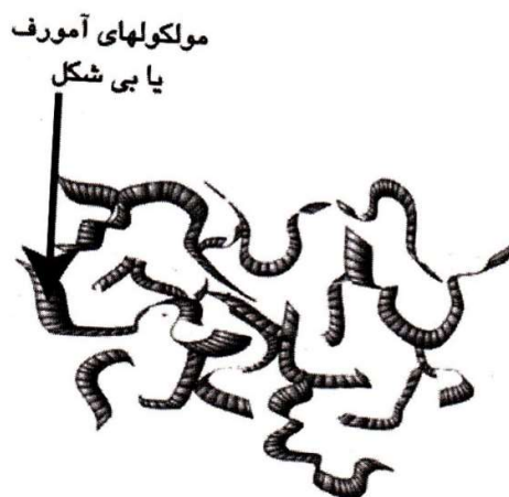
ساختار مولکولی پلیمر بی شکل (آمورف)
